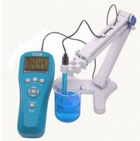
Портативный рН-метр рН-420 предназначен для измерения активности ионов водорода (рН), окислительно-восстановительного потенциала (Еh) и температур в растворах, питьевой воде, пищевой продукции и сырье, объектах окружающей среды и производственных систем непрерывного контроля технологических процессов.
