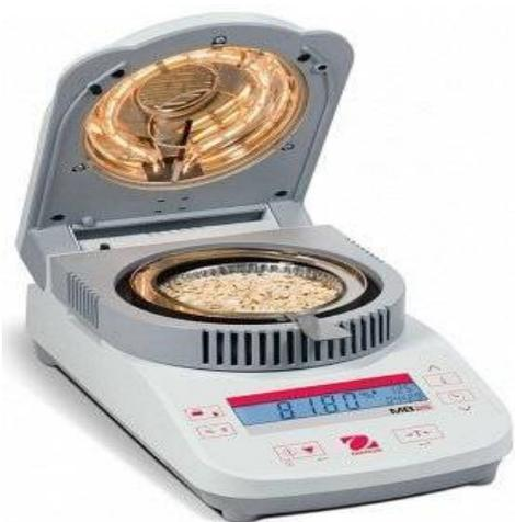
**ОHAUS анализаторы влагосодержания MB25** — это анализатор влагосодержания с диаметром весовой чашки 90 мм, НПВ 110 г, разрешением 0,05%, воспроизводимостью 0,2% для образцов массой 3 г и 0,05% для образцов массой 10 г.
