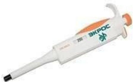
**Дозатор «ЭКРОС»** предназначен для лабораторий различного профиля, таких как: микробиология, иммунология, биохимия, генетика а так же используется в ряде медицинских учреждений, для объемного дозирования проб биожидкостей и реактивов.
