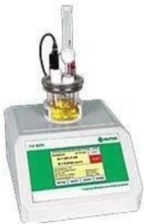
**Титратор ПЭ-9210** предназначен для быстрого и точного определения содержания влаги в широком спектре продуктов и материалов, находящихся в жидкой, газовой или твердой фазе методом кулонометрического титрования. Титратор может использоваться в аналитических и химико-технологических лабораториях, в органах контроля и надзора.
