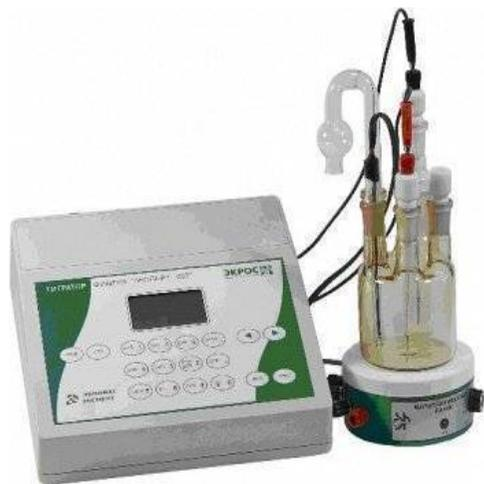
**Кулонометрический титратор по Карлу Фишера «Эксперт-007М АП»** с бипотенциметрической и биамперметрической индикацией конечной точки титрования (2 режима). Позволяет определять микроколичества влаги от единиц ppm. по ГОСТ 24614, EN ISO 12937 (IP № 438/01) и др. Оценка правильности результатов и поверка прибора может проводиться по дистиллированной воде.
