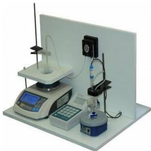
**Последняя стадия - определение аммонийного азота с помощью титрования.**
